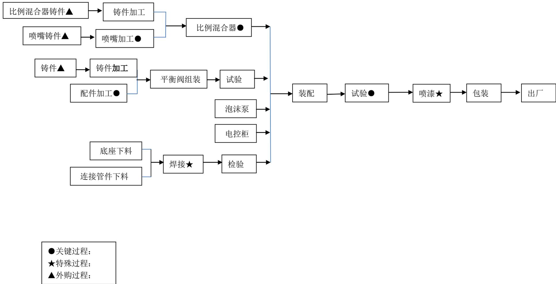
平衡式比例混合装置工艺流程图（新乡市金升消防科技有限公司）
